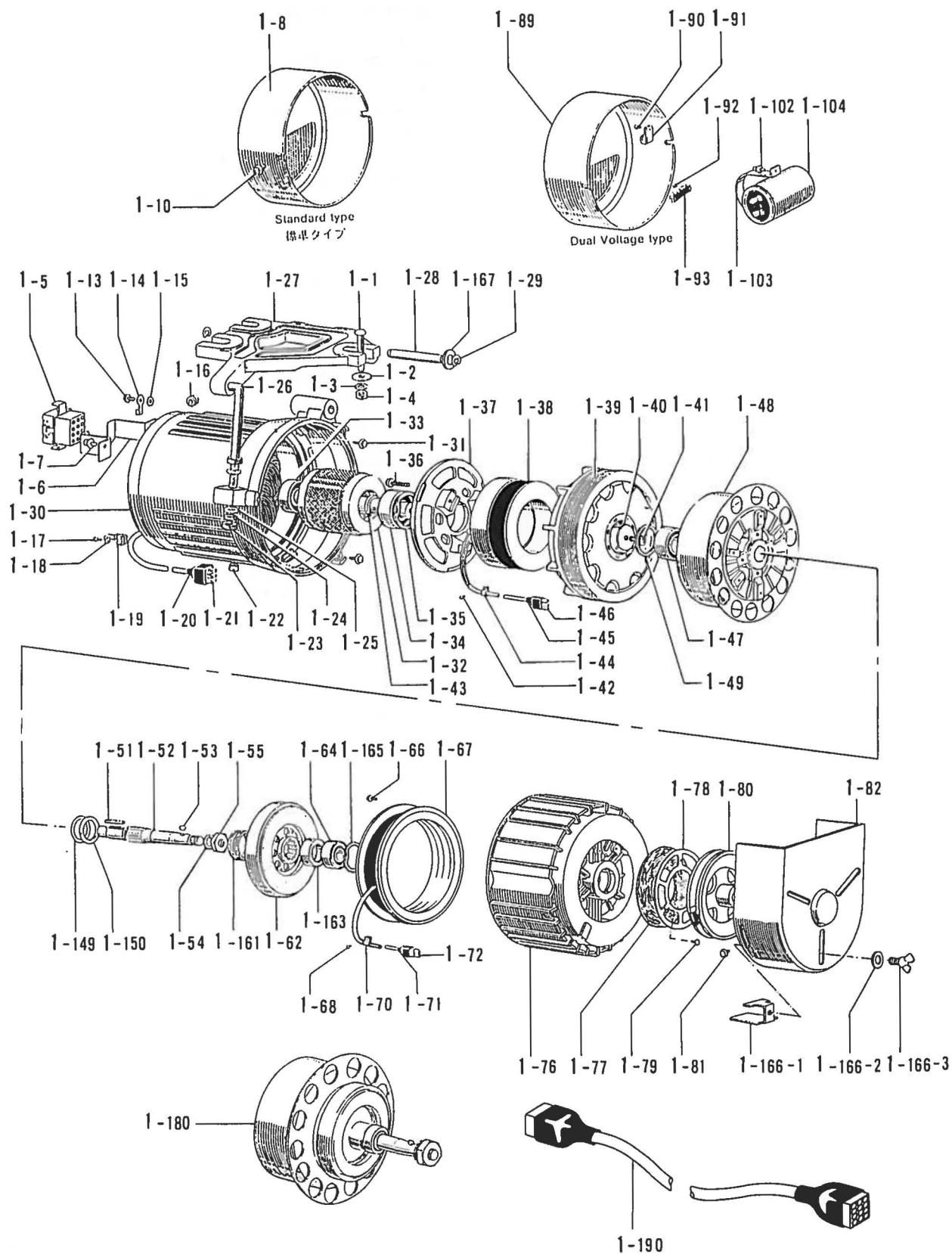
X2. モータ関係 / Motor mechanism / Motor / Mécanisme du moteur / Mecanismo del motor
