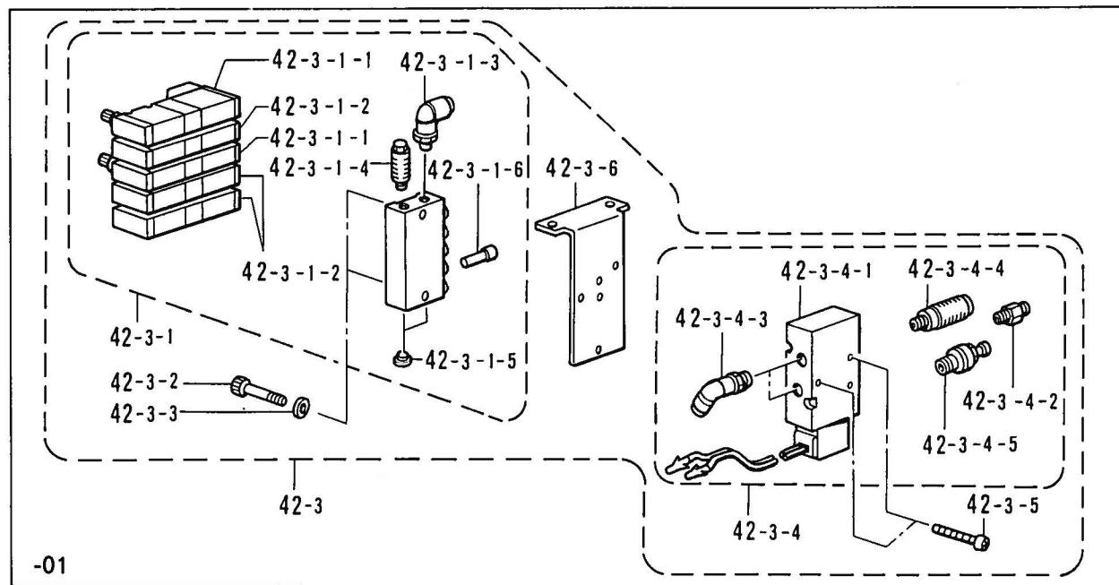
U2. 空圧関係 / Air pressure mechanism / Luftdruck /
