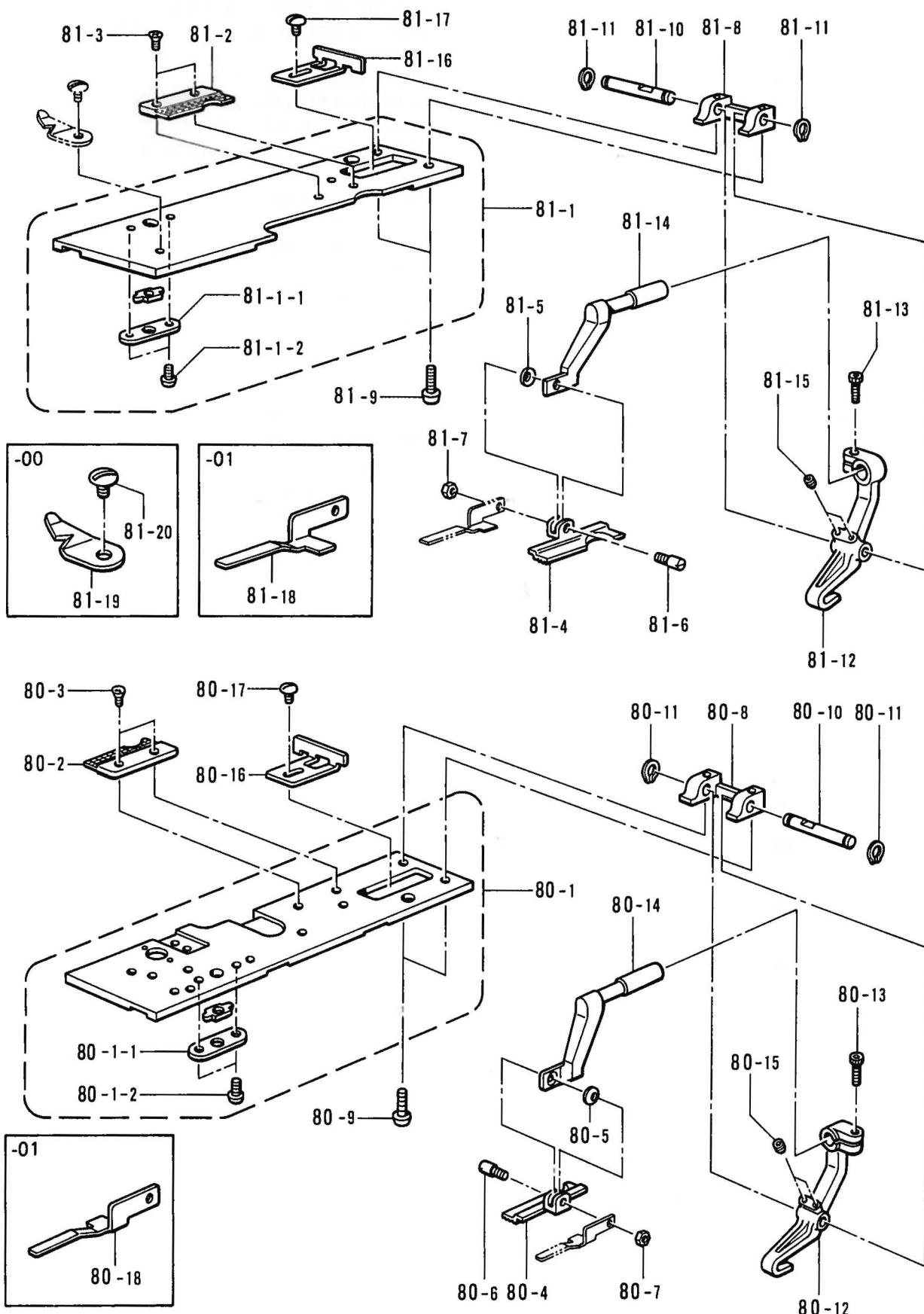
F2. 押工関係 / Presser foot mechanism / Stoffdrückerfuß /
